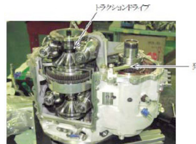
図11 トラクションドライブ式IDG (T-IDG) MkII試作 Fig.11 Traction drive IDG (T-IDG) prototype Mk II
